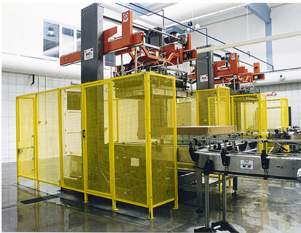
trasportatore di introduzione palette piene predisposto per il contenimento di una paletta in lavorazione ed una in attesa
