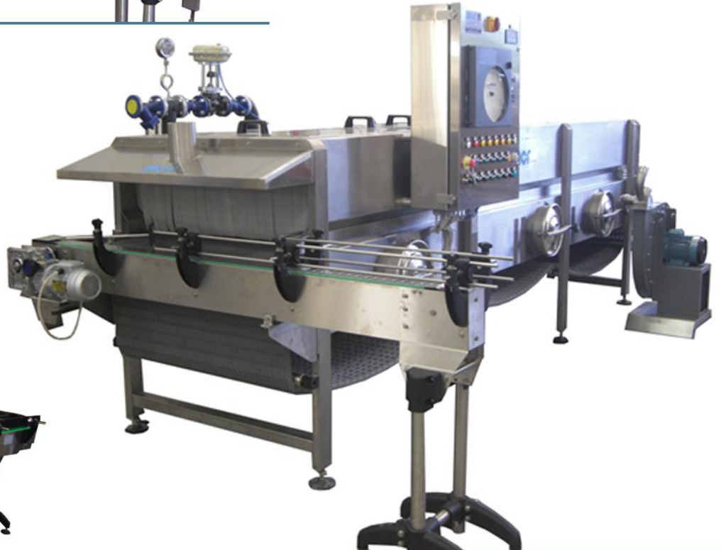
Quadro con sistema di registrazione elettronica della temperatura con display videografico
